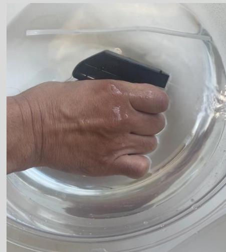
⑥ 詰まりが解消したらノズルをヘッドに取り付け、水を入れた別容器から水を吸い上げて、スプレーへッドに残っているお湯・クエン酸溶液を全て取り除きます。
